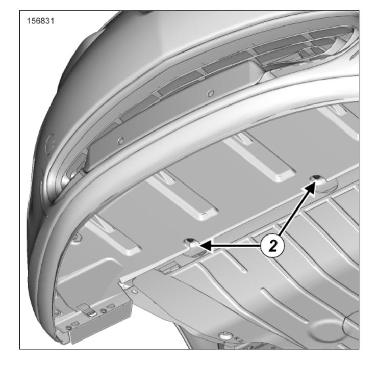
Déposer les vis inférieures du convergent de bouclier avant(2).
