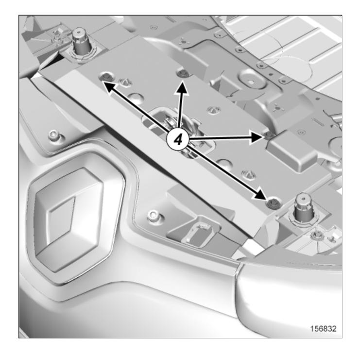
Déposer les vis supérieures du bouclier avant(4).
