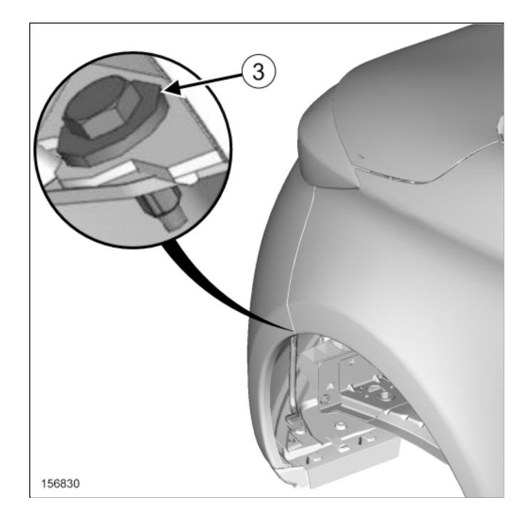
Déposer la vis latérale du bouclier avant(3).
